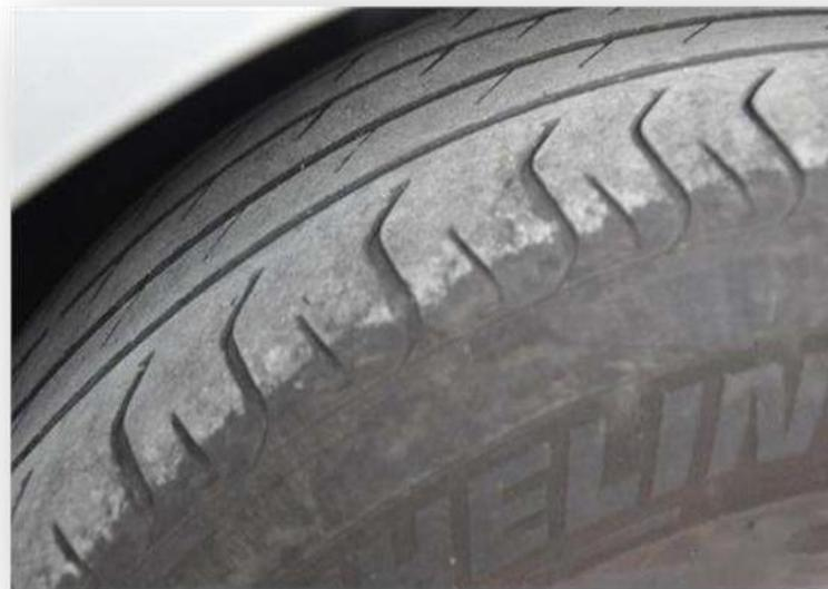
运动副之间的摩擦将导致机件表面材料逐渐损耗形成磨损。
